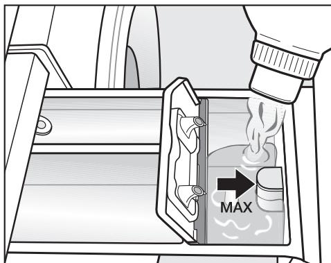
■ Наполните кондиционером, добавкой для придания формы или жидким крахмалом ячейку ☈. **Не превышайте максимальную высоту наполнения.**
