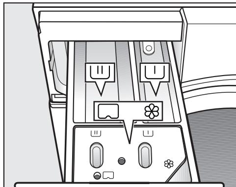
■ Выдвиньте отсек для моющих средств и заполните ячейки моющим средством.
