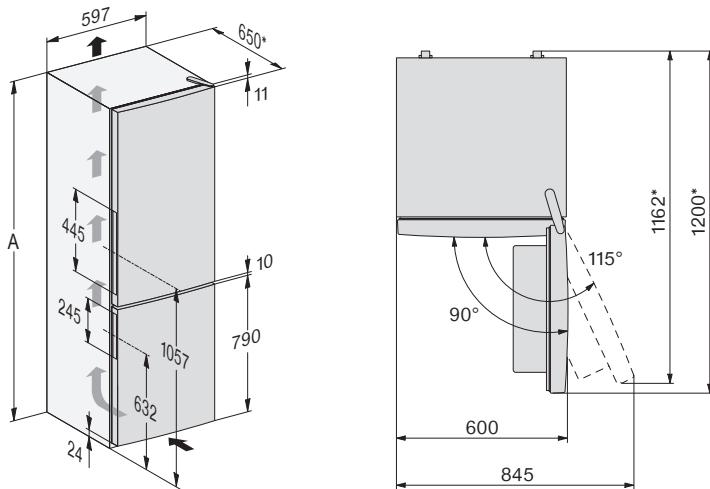
\* Размер без смонтированных проставок для соблюдения расстояния от стены. При использовании прилагаемых проставок глубина прибора увеличивается примерно на 36 мм.
