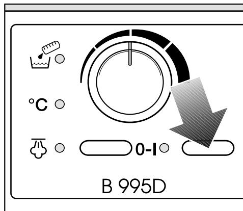
Гладильная машина включается и выключается с помощью выключателя **I-0**.
