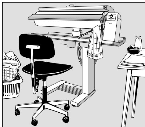
Проследите, чтобы машина была в горизонтальном состоянии, тем самым Вы обеспечите равномерное поступление пара.
